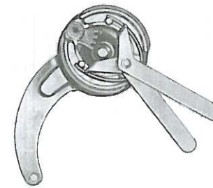
Bild 4. Fjäder för bromsback lossas
