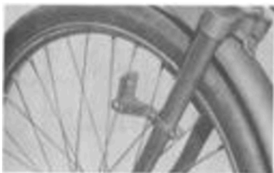
[Bild 14. Framgaffelhållare för strålkastare]
