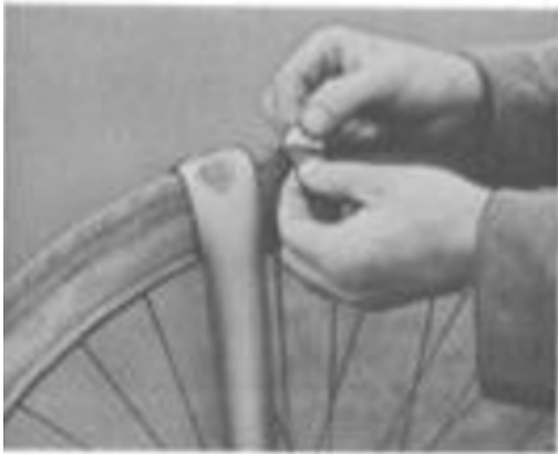
[Bild 39. Fastsättning av reparationslapp]
