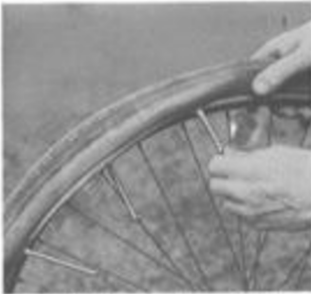
[Bild 37. Avtagning av däck]
