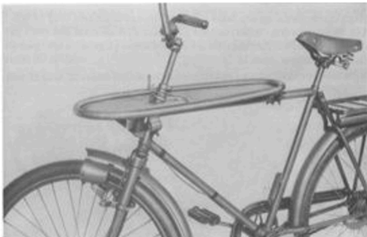
[Bild 27. Cykelplatta fastspänd för transport av hund]
