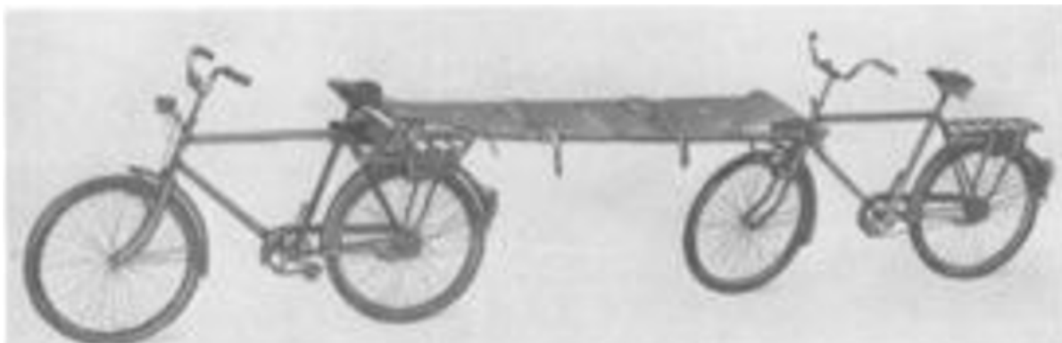
[Bild 29. Sjukbåren i de två galgarna på cyklarna]
