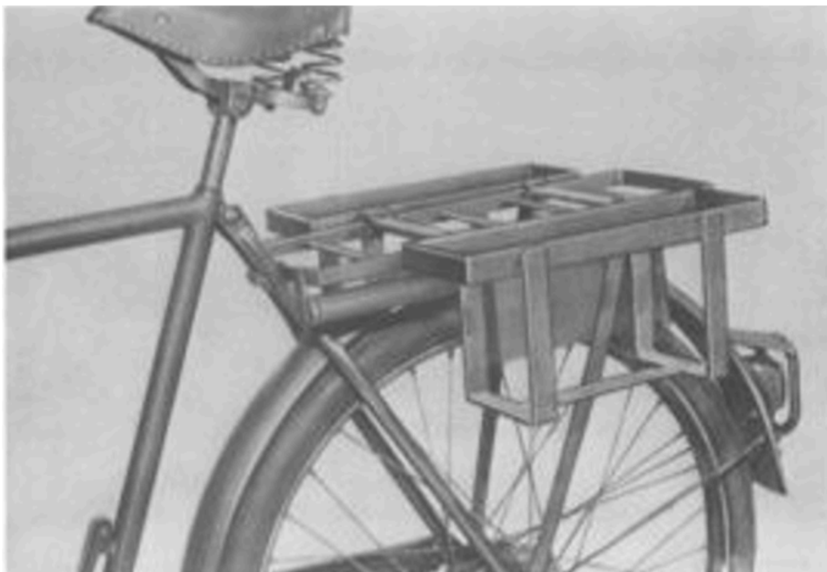
[Bild 26. Hållare för två bandlådor på cykel]
