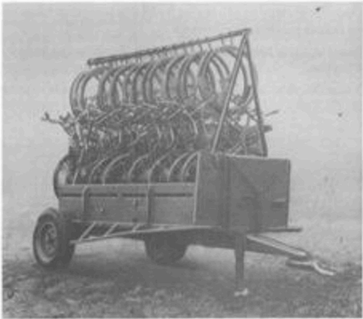
[Bild 33. Ctp-överrede för 20 cyklar på traktorkärre 1 ton]
