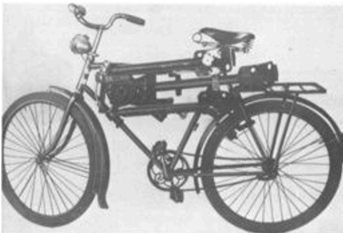
[Bild 25. Lavett fastspänd i beslagen]
