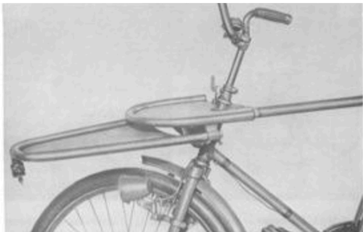
[Bild 28. Cykelplatta fastspänd när hund inte skall transporteras]
